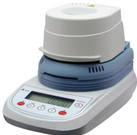
**Termobilancia di precisione a lampada Alogena, con sistema di microprocessori, per la determinazione del contenuto di umidità nei prodotti.**
