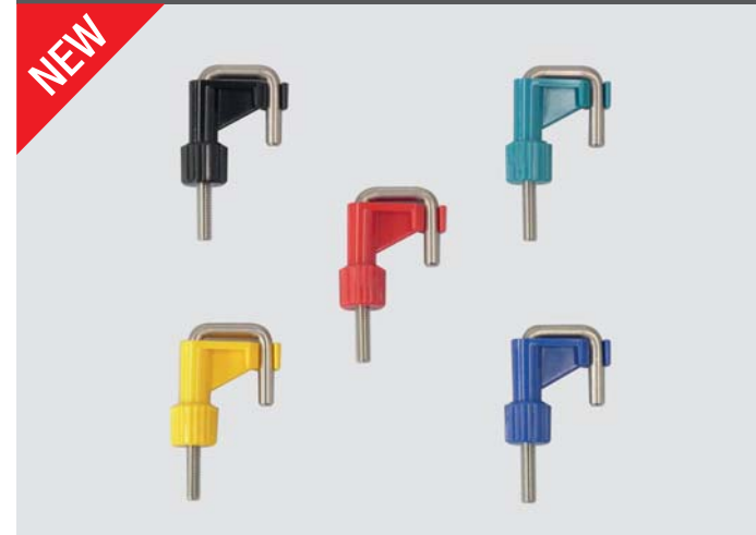
Morsetto in acciaio inox e polycarbonato, autoclavabile, per tubi con diametro fino a 21 mm. I morsetti Click & Close possono essere aperti o chiusi senza dover essere completamente svitati. La manopola di regolazione consente un controllo del flusso molto preciso; il flusso può anche essere chiuso del tutto. Il tubo viene compresso su un'ampia superficie, in modo che non venga danneggiato. Il morsetto stringitubo può essere montato sui tubi flessibili anche dopo che sono stati collegati.
