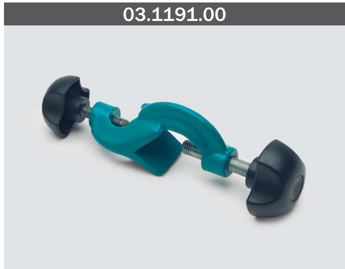
MORSETTO PER AGITATORE MECCANICO VERTICALE In lega pesante, verniciato con vernice epossidica resistente al calore e agli acidi. Dotato di un'apertura per aste con diametro fino a 30 mm e di una seconda apertura per aste con un diametro fino a 20 mm. CLAMP FOR VERTICAL MECHANICAL STIRRER Heavy alloy, painted with heat and acid resistant epoxy paint. Equipped with an opening for rods with a diameter up to 30 mm and a second opening for rods with a diameter up to 20 mm.
