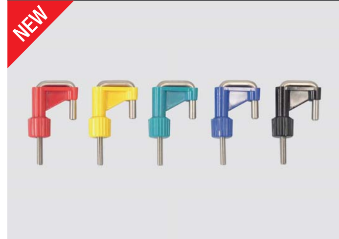
MORSETTO STRINGITUBO AUTOCLAVABILE Morsetto in acciaio inox e polycarbonato, autoclavabile, per tubi con diametro fino a 21 mm. La manopola di regolazione consente un controllo del flusso molto preciso; il flusso può anche essere chiuso del tutto. Il tubo viene compresso su un'ampia superficie, in modo che non venga danneggiato. Il morsetto stringitubo può essere montato sui tubi flessibili anche dopo che sono stati collegati.
